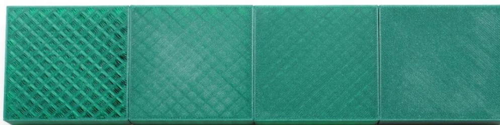
Hình 12: Top Layer _Từ trái sang phải, lớp 1, 2, 3 và 5 trên cùng, được in ở độ cao lớp 0,1 mm.
